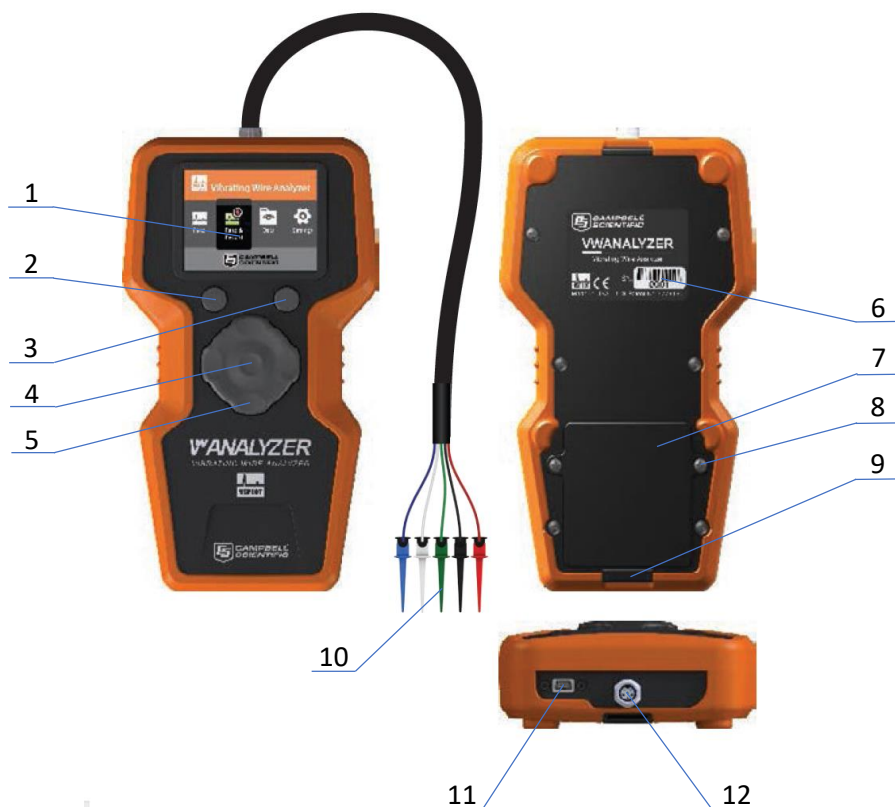
Рисунок 2.1. Общий вид портативного регистратора данных VWA.
