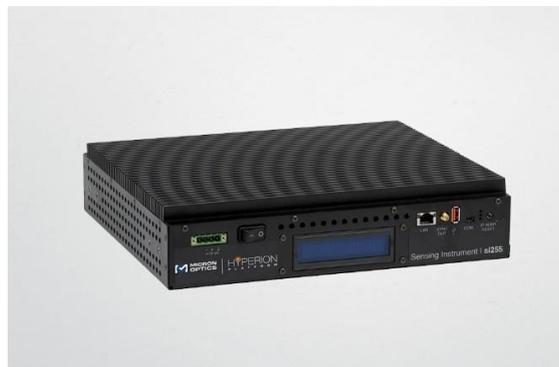
Si255 – оптический интеррогатор, предназначенный для непрерывного мониторинга объектов с большим числом информационных каналов. Si255 подходит для опроса различных типов датчиков, в том числе ВБР, длиннопериодных волоконных решеток, Фабри-Перо и Маха-Цандера. Si255 имеет встроенный эталон длин волн для обеспечения высокой точности измерений.
