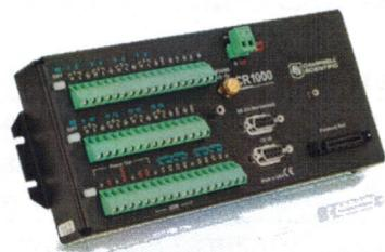
Рисунок 1 - Общий вид регистраторов данных многофункциональных CR1000
