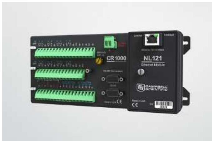
Интерфейс NL121 позволяет регистратору данных CR1000 подключаться через Ethernet. Используя данный модуль регистратор данных получает доступ к различным протоколам работающим через Интернет и сети (PakBus, Modbus, и DNP3 через TCP, WEB, email, передача файлов и тд). Таким образом с помощью любой IP сети (локальной или Интернет) можно управлять даталоггером и получать данные измерений.
