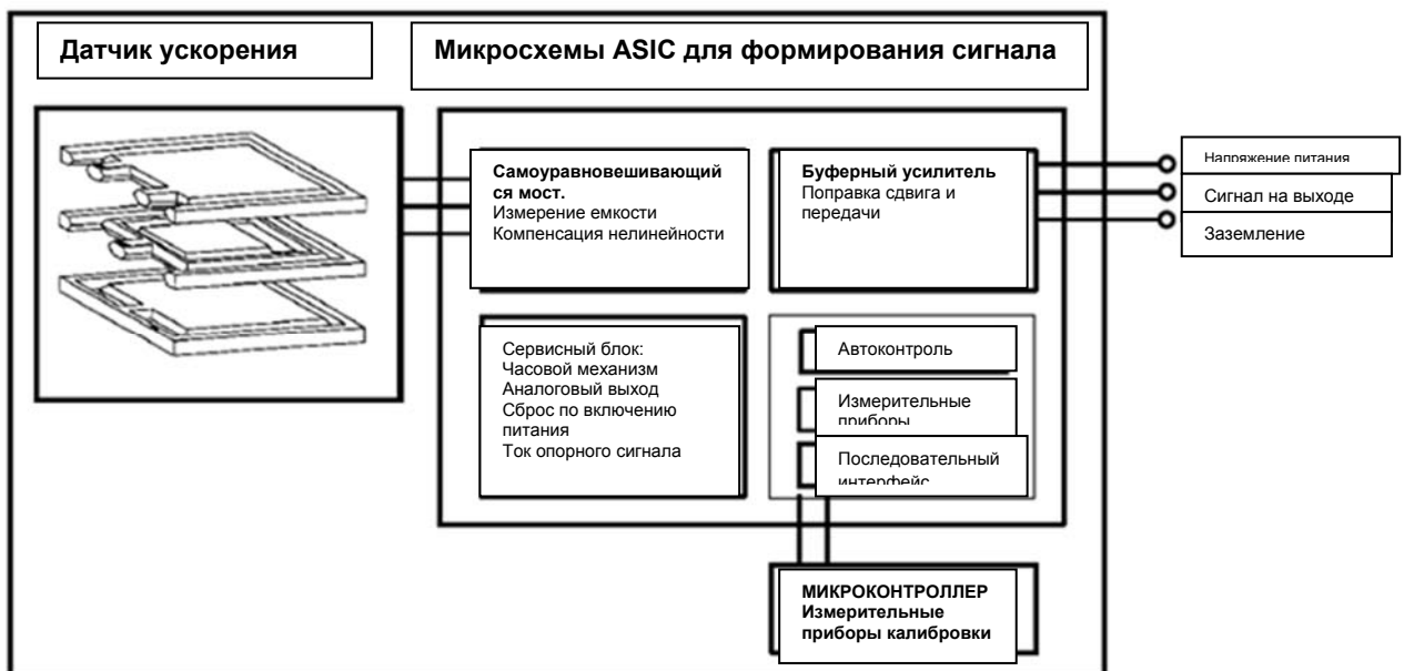
Рис. 2 Блок-диаграмма MS2002+ чувствительного элемента ускорения
