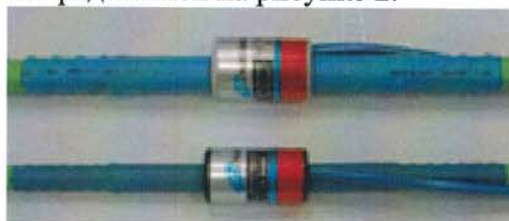
Рисунок 2 - Внешний вид датчиков деформации арматурных SJ-7500
