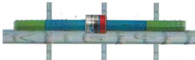
Рисунок 1 - Крепление датчиков к стержню рабочей арматуры
