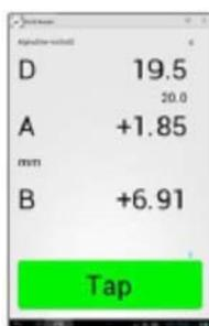
5. На Считывающем устройстве отобразится следующая текущая глубина. Поднимите зонд до этой глубины и выждите некоторое время до появления неизменных показаний, затем нажмите на кнопку записи.
